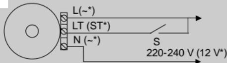
Esquema de conexión a la corriente eléctrica del ventilador provisto con el temporizador / temporizador con el sensor de humedad, sin el interruptor incorporado.
