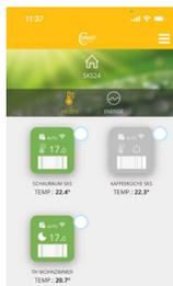
Alle AERO24 Heizungen verfügen über den Thermostat AERO24 Smart DSD. Alle Heizkörper (auch gemischt) können über die App bedient werden, durch die direkte Internetanbindung über Ihren WLAN Router bzw. Smart Control App.
